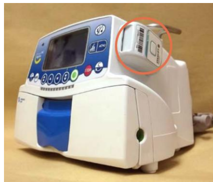
Figur 11 – Eksempel på aktiv ID-brikke på MTU
