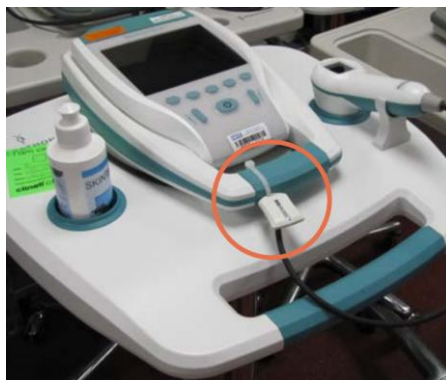
Figur 9 – Eksempel på passiv RFID brikke på MTU
