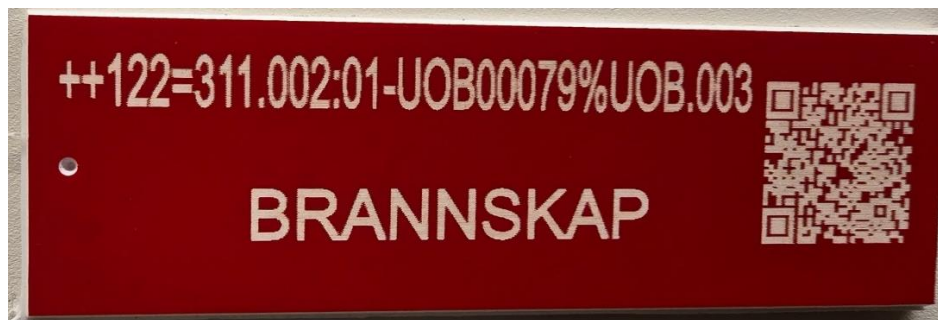
Figur 8 – Skilt for brannskap i sykehus (kilde: VVHF)
