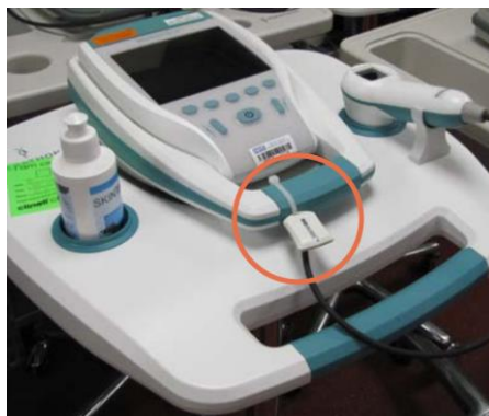
Figur 9 – Eksempel på passiv RFID brikke på MTU
