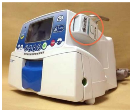
Figur 11 – Eksempel på aktiv ID-brikke på MTU
