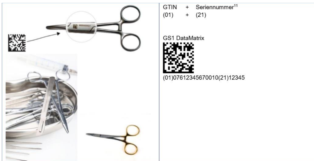
Figur 5 - Instrument merket med GS1 Datamatrix
