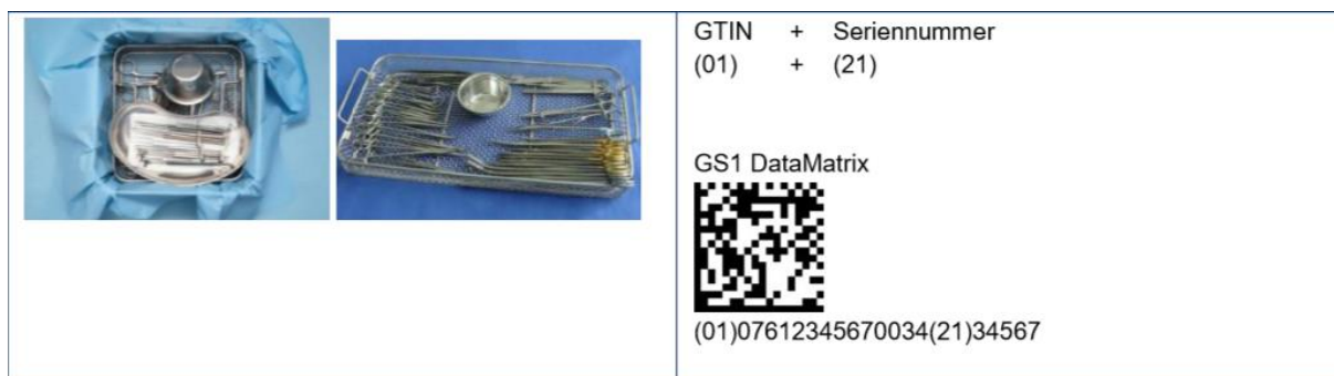
Figur 4 - Brikke med instrument merket med GS1 Datamatrix
